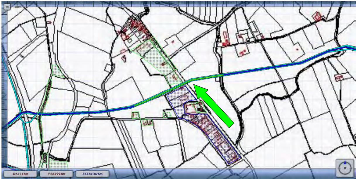
Figuur : Kilometer leiding van de A-642 met het hoogste groepsrisico (groen). In het blauw is de gehele leiding aangegeven.
